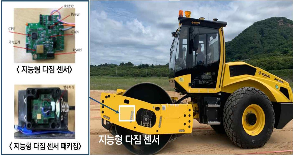
〈그림 1-1〉 지능형 다짐관리 장치가 부착된 진동롤러
